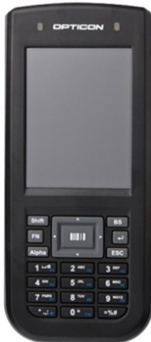
Das OPTICON H-32-2D ist ein auf WINDOWS-CE basierender PDA mit integriertem Scanner für alle bekannten 1D- und 2D-Strichcode sowie OCR-B Schriften.
